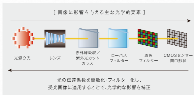
デジタルレンズオプティマイザの原理 付属ソフトウェア「Digital Photo Professional」を介さず、カメラ単独で完結できるため、パソコンを媒介せずに高画質な作品づくりが行えます。
